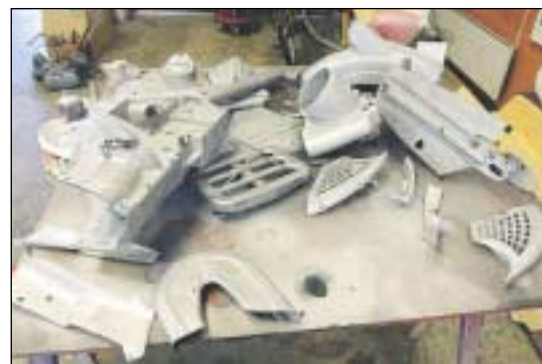
Arbetet har redan påbörjats på senaste projektet. Några kartonger moppedelar ska bli en blåvit Zündapp av 1964 års modell. Sandblåstringen avslöjar att det här inte handlar om bockad plåt, utan gjuten lättmetall.
